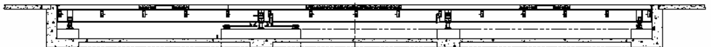
Diseño de ingeniería – ejemplo de balanza para camiones instalada en mini fosa.
